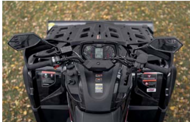
Mygtukų išdėstymas ant vairo yra labai patogus. Po kaire ranka patogiau naudoti stabdžių jungtį ant priekinių ratų. Stabdant koja, stabdžiai veikia kaip „kombinuotas stabdys“, stabdydami visus keturis ratus. Rankinio stabdžio svirtis yra priešais droselio svirtį, kad būtų išvengta atvejų, kai keturračiu važiuojama, o rankinis stabdys „įjungtas“
