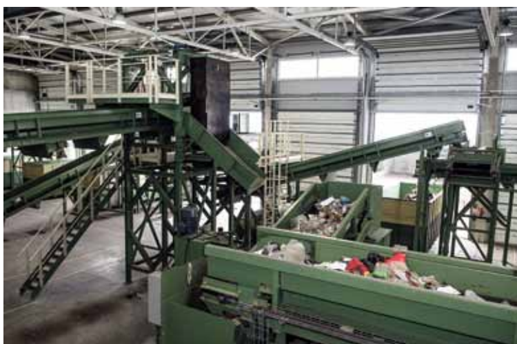
Mechaninio rūšiavimo įrenginiuose iš mišrių komunalinių atliekų srauto atskiriama įvairi pakuotė ir antrinės žaliavos/ARATC archyvo nuotrauka
